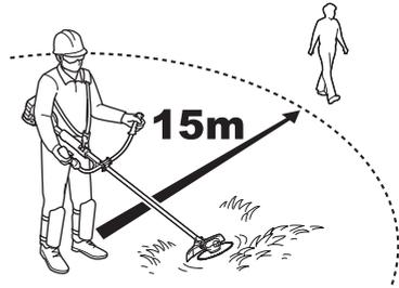
**17** 本機を使用している人に近づくときは、使用者から 15m 以上離れた位置で合図し、スイッチを切り、刈刃の回転停止を確認してから近づいてください。
