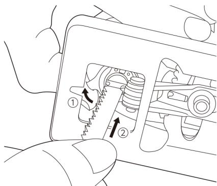
2.ブレード固定レバーを回しながら①)ブレードホルダーの溝にブレードの凸部がかくれるまで差し込みます。②)
