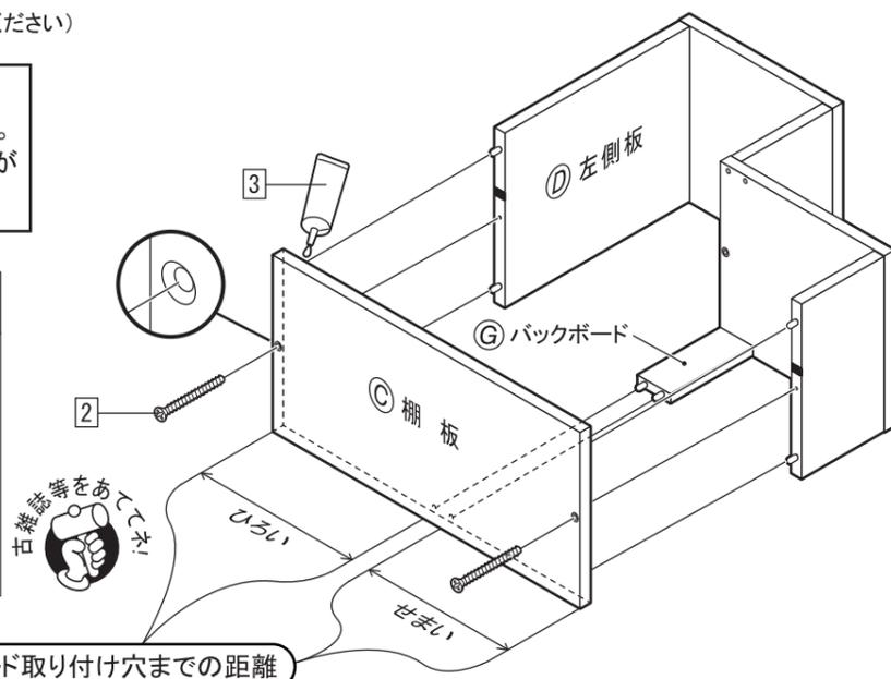
端からバックボード取り付け穴までの距離
