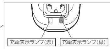
2. バッテリーパックを充電器の挿入口の底にあたるまでしっかりと差し込みます。
