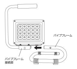
2.本体のパイプフレーム接続部とパイプフレームの穴を合わせて、パイプフレーム取付ネジとスペーサーでしっかりと固定してください。
