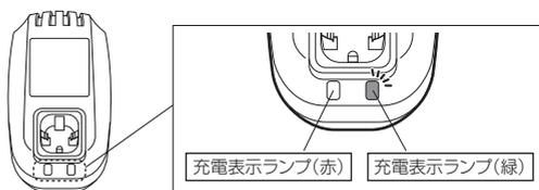
2. バッテリーパックを充電器の挿入口の底にあたるまでしっかりと差し込みます。
