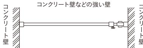
※やむを得ず弱い壁へ取り付ける場合、壁の下地にサンなどが通っている所を選び、あて板などで壁面を補強してください。(但し、表示耐荷重は得られません)
