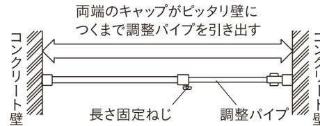
両端のキャップがピッタリ壁につくまで調整パイプを引き出す
