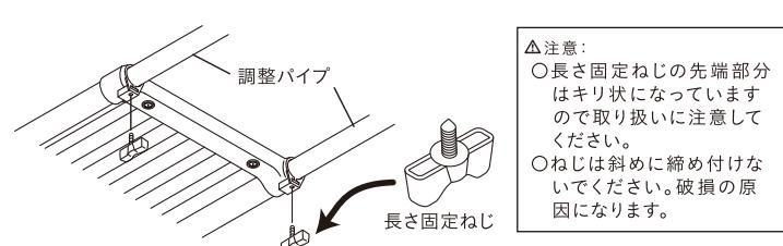
3 取り付ける壁面一杯に(両端のキャップがピッタリ壁につくまで)調整パイプを引き出してください。
