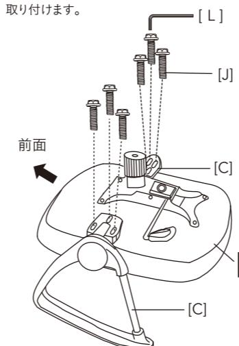
3 3 で組み立てた座面に [A] 背面シートを図のようにセットし、[K] 背面シート固定ネジを [L] 六角レンチでしっかりと取り付けます。
