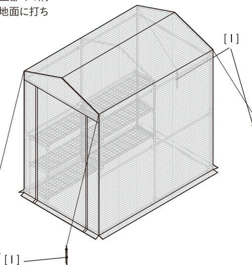
※地面が土の場合、[H] アンカーピンで本体を固定してください。コンクリートなど地面が固い場所では砂袋を敷く等、転倒防止処置をしてからご使用ください。
