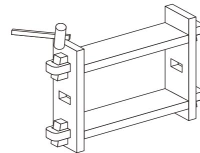
3 くさびを全て外したら、支柱から棚を取り外します。
