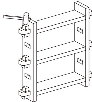
3 くさびを全て外したら、支柱から棚を取り外します。
