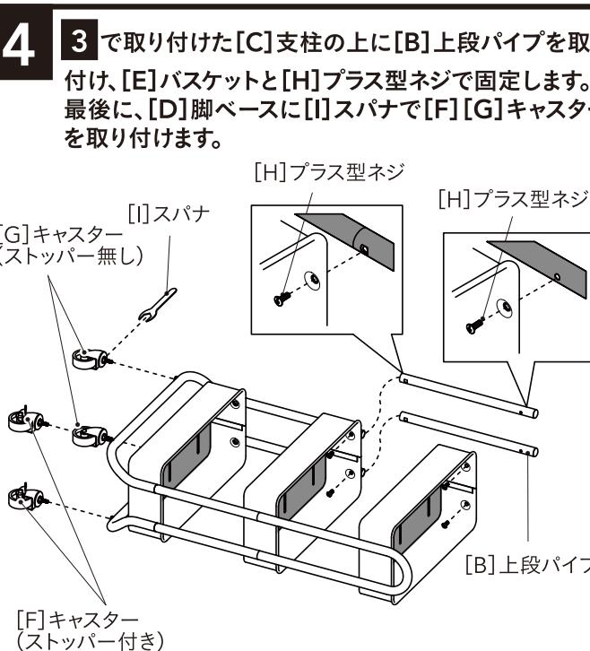
※[A] 枠フレーム側に[F] キャスター(ストッパー付き)、[B] 上段パイプ側に[G] キャスター(ストッパー無し)を取付けてください。
