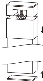
2×4材の床面に付属のすべり止めシートを取り付けてください。
