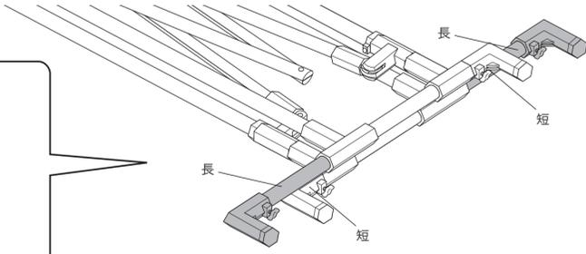
**2** ①ジャバラ固定リングをゆるめ、本体を開きます。脚部が下になるように本体をたて、脚部(長)が並行のコの字になるようにします。
