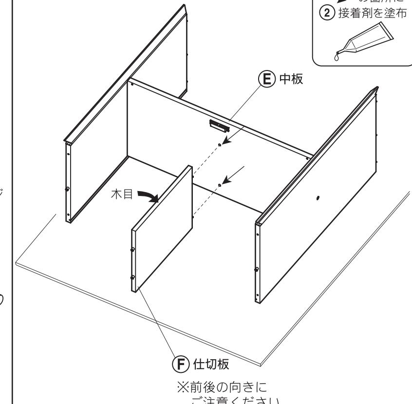
4 (B) 側板(左) (C) 側板(右) (F) 仕切板と (D) 底板の組み立て
