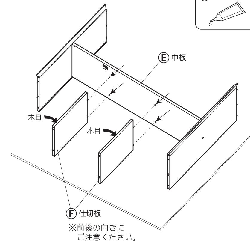
**4** (B) 側板(左) (C) 側板(右) (F) 仕切板と (D) 底板の組み立て
