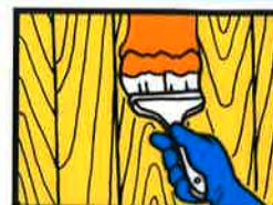
③ハケ塗りで、木材表面に1m当たり300㎠程度処理してください。(処理回数は2回が標準です。2回目は2時間以上たってから処理してください。)
