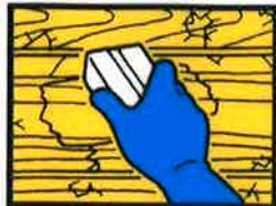
①塗る面のゴミ、汚れ、油分、カビを取りしてください。パンキ、ニスなどの旧塗膜はサンドペーパーなどで完全に取り除いてください。
