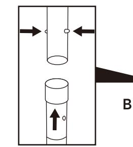
**2** パラソルの内側を手で押し上げてパラソルを開き、軸の穴にピンを挿して固定します。
