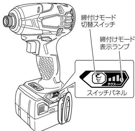
締付けモード切替機能の設定例
