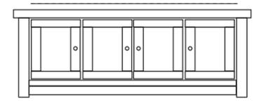
下記の様に扉板がずれている時は、天板を矢印の方向に押し調整しながら裏板ストッパーを取り付けてください。
