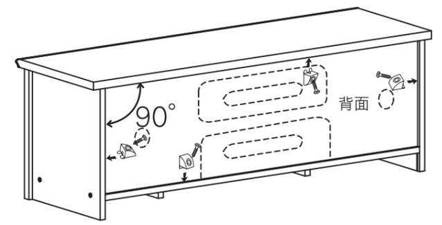
裏板と側板、天板、底板の隙間に裏板ストッパーを差込み、ねじで固定してください。その際、天板と側板が90°になるように取り付けてください。
