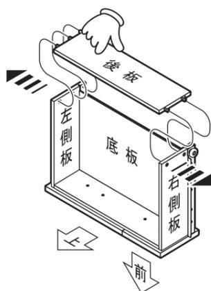
⑤ 側板の穴に後板の位置を合わせ、左右の側板をゆっくりと確実に押し込んで下さい。
