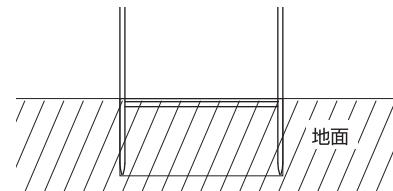
杭部とステー部は確実に埋めてご使用ください。安定が悪い場合はモルタルで固定するなど、転倒防止処置をしてからご使用ください。
