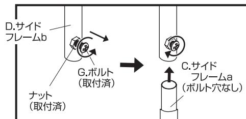
※G.ボルトは差し込み側のフレームを押さえつけて固定します。C.サイドフレームaにはボルト、ナットは取り付けられていません。
