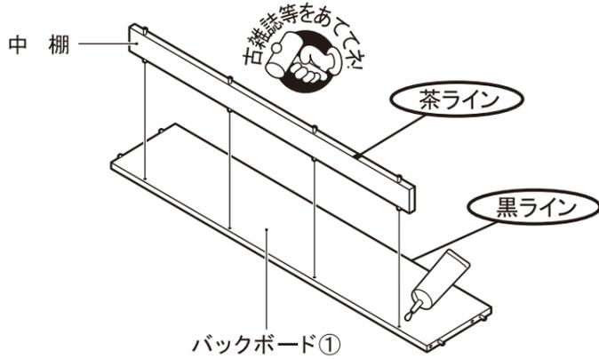
7 中棚にDバックボード②を取付けます。
