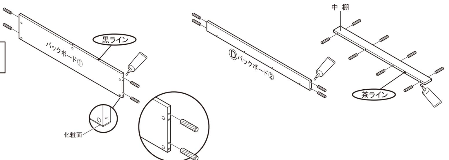
5 左右側板にジョイントボルトを取付けます。
