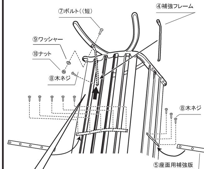
③サイドフレームと①板の角度が90°になるよう矢印の方向にしっかりと押し、⑧ネジBで固定します。
