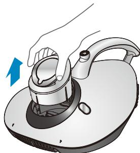
2 水を張ったバケツに標準フィルターを付けたままのダストボックスを沈め、水の中で標準フィルターを外してすすぎます。(ハウスダストが飛び散るのを防ぐため)
