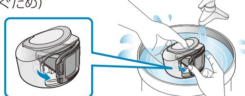
3 表面のハウスダストを取り除き、標準フィルターとダストボックスを流水で洗い流します。
