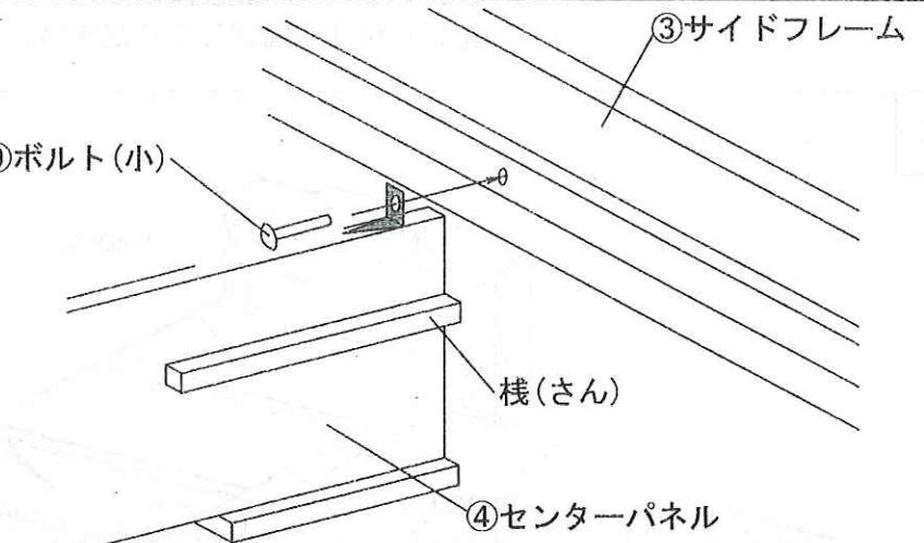
④センターパネルの金具に⑨ボルト(小)を通して、③サイドフレームを仮止めします。
