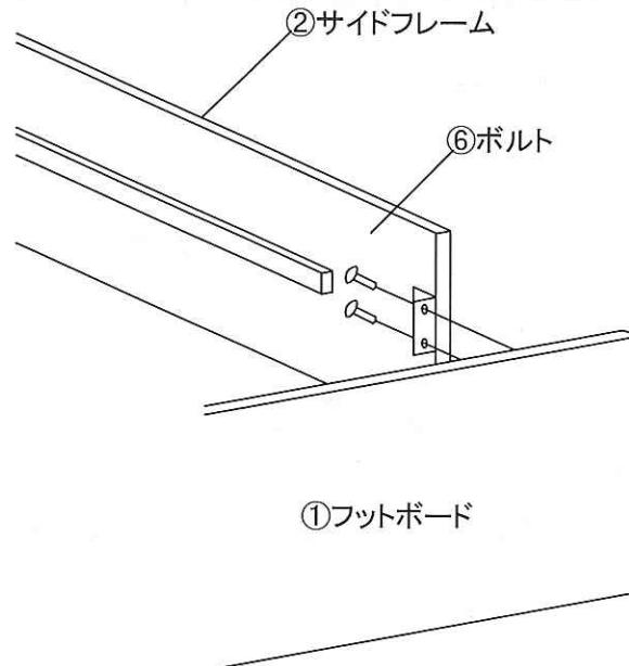
後側も前側と同様に、⑥ボルトを②サイドフレームの金具に通し仮締めします。
