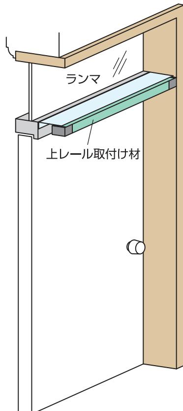
ランマとドアの間に上レール取付け材を取り付け、その下に網戸を取り付けます。
