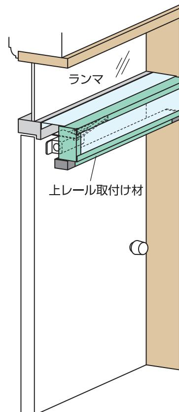
ドアクローザをよけるように上レール取付け材をドアクローザの下に取付けます。
