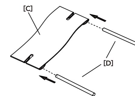
3 図のように [A]フレームに [D]バーと [C]生地を取り付けます。
