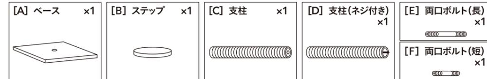
1 [A]ベースに [D]支柱(ネジ付き)を取り付けます。
