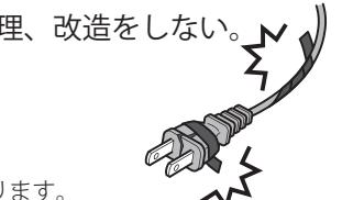
傷んだ電源プラグや電源コードの部品は、絶対に交換、分解、修理、改造をしない。
