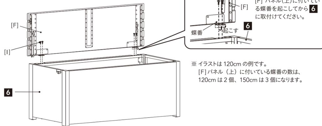
**8** ガススプリングを [I] 平ネジで **7** に固定します。
