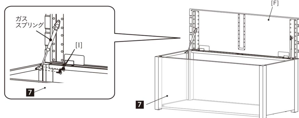
**9** **8** に [J] エアダンパー取付金具を [H] なベネジで固定し、エアダンパー側を回して繋ぎ合わせます。
