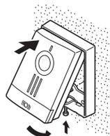
先に玄関子機为天面部を取り付け台に入れて、底面部を押し込んでから、下部の止めネジを締めて固定してください。
