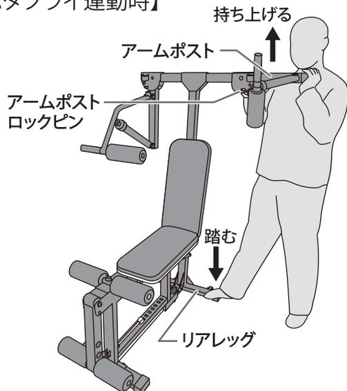
バタフライ運動用に変形させる際はリアレグを足で踏み、本体を固定した状態でアームポストを持ち上げながら、アームポストロックピンを差し込んでください。
