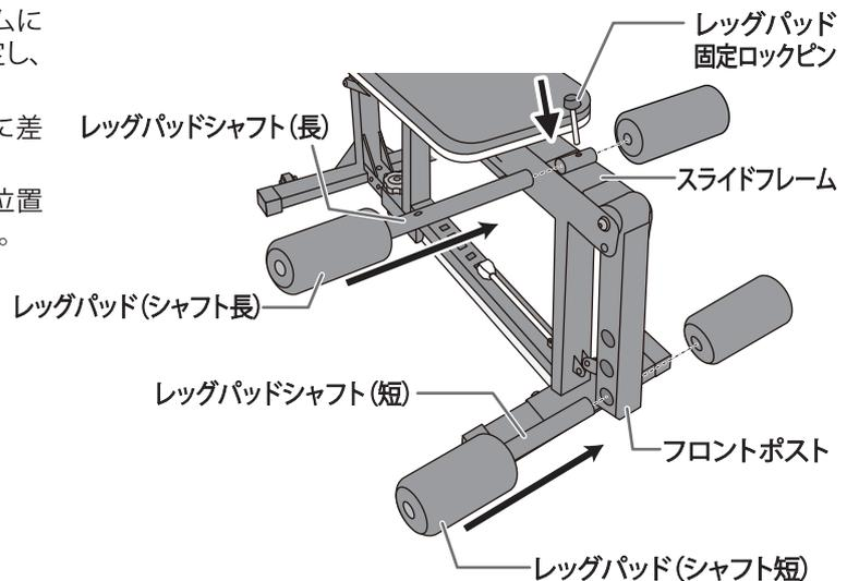
フロントポストを固定したいときはレッグパッド固定ロックピンをフロントポスト上部側面の穴に差し込みます。
