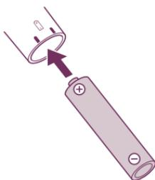
3 電池キャップの(■)が本体左側の(■)に合うようにはめ、本体右側の(■)と合うまで図の矢印方向に回す。
