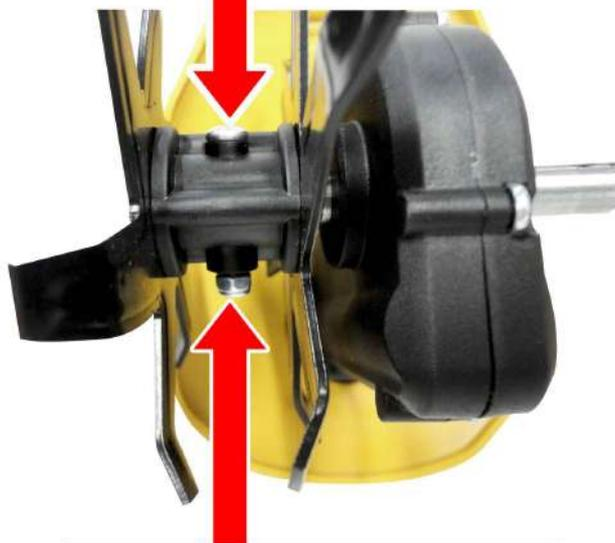
ナットを溝にハマて押さえながらボルトを締め込む
