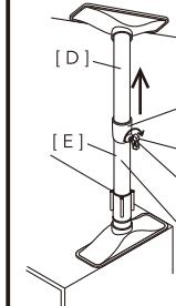
3 調節グリップを矢印の方向(シールのつっぱり方向)に徐々に回して圧着固定させます。
