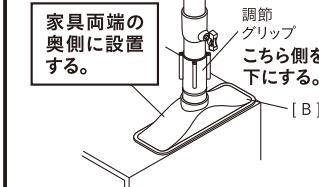
2 [D] 外パイプを垂直に天井いっぱいまで持ち上げた状態にし、[C] 長さ固定ねじをしっかりと締めつけ[E]中パイプを固定します。(締めつけると中パイプに穴があいて長さが固定されます。)
