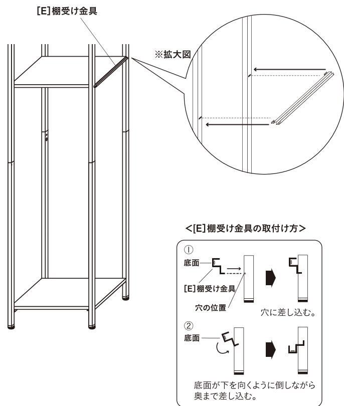
**6** [F]サイドパネルのツメがある方を上にして、[E]棚受け金具に上から引っ掛けるよう取付ける。
