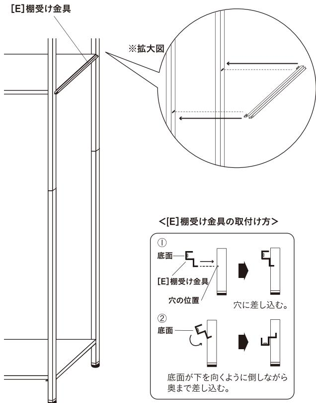
**6** [F]サイドパネルのツメがある方を上にして、[E]棚受け金具に上から引っ掛けるよう取付ける。
