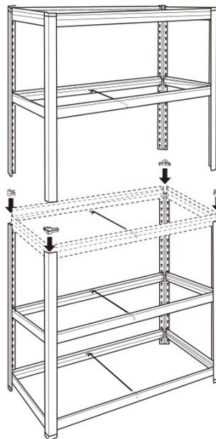
【A】角柱4本に【I】柱接続用パーツをはめ込み
