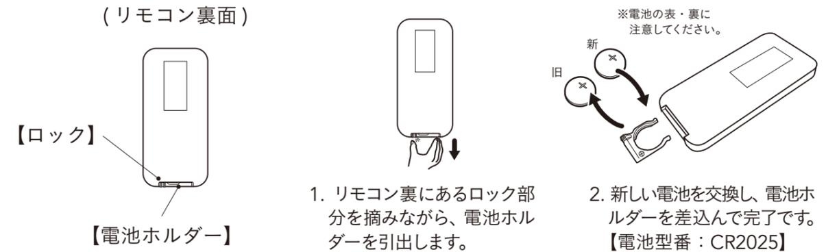
※電池の極性(+)を間違えても電池ホルダーを本体に差込むことができます。電池交換後、リモコンが正常に動作するか確認してください。正常に動作しない場合は、電池の極性(+)を確認してください。
