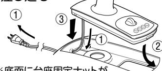
\*底面に台座固定ナットが付いていますので、先に取り外してください。
