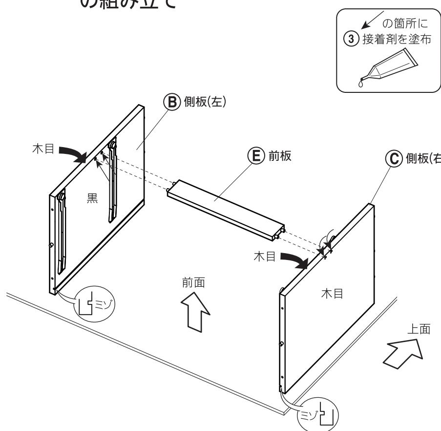
**4** **B**側板(左) **C**側板(右)と**D**底板の組み立て
