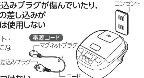
**コードを傷つけない** 無理に曲げたり、引っ張ったり、ねじったり、たばねたり、高温部に近づけたり、重いものをせたり、挟み込んだり、加工したりするとコードが破損し、火災・感電の原因になります。
