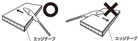
アートランバーの幅方向をカットする場合、必ずエッジテープのある側からカットを始めてください。
